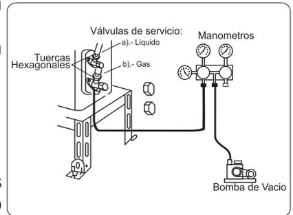
5. Si se presentó una pérdida de vacío, esto indica que el sistema tiene alguna fuga de refrigerante, si es tal el caso, debe abrir la válvula de servicio del lado de baja presión, para permitir la liberación de refrigerante hacia el sistema. Cierre después de 5 segundos aproximadamente para tener una presión deseable y detectar fuga.
